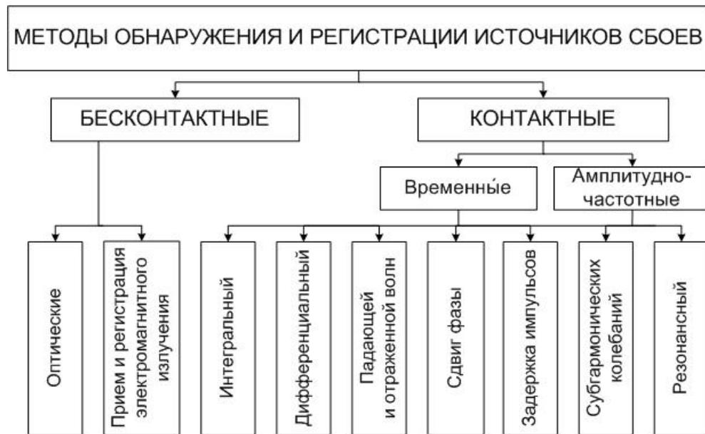
Рис. 1. Классификация методов обнаружения и регистрации источников сбоев
